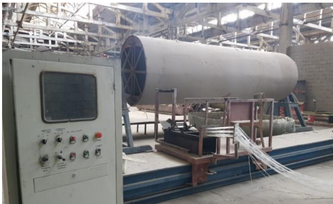
Сурет-3.1 – Hasanat Group базасы бойынша шыныпластиктен корпус жасау көрінісі [1].
